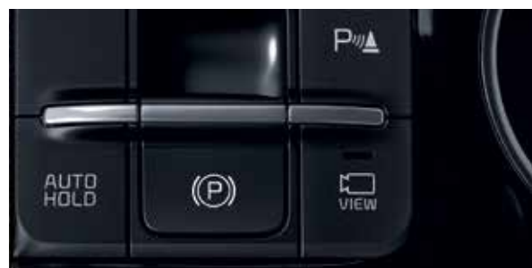
Электронный стояночный тормоз (EPB)
