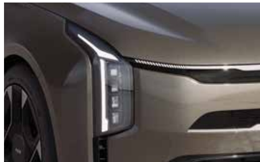
Матрицалық жарық элементтер жүйесі бар жарықдиодты алдыңғы фаралар
